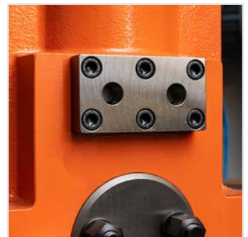
11. Mechanical release of the ram / mechanische Stösselentriegelung / Mechaniczny bezpiecznik przeŃiŃeniowy
