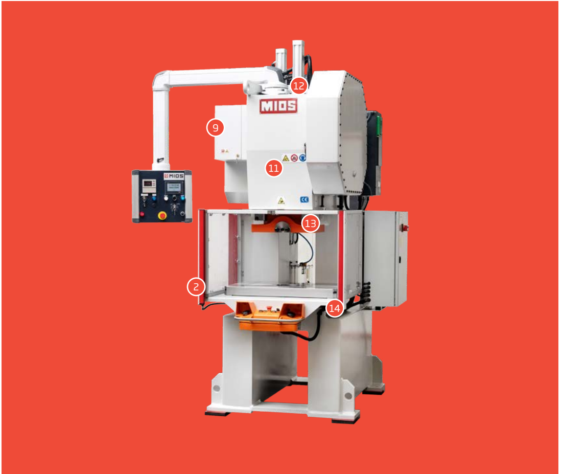
2. Electronic safety light curtains/ Elektronischer Sicherheits- Lichtvorhang / Elektroniczne fotobariery bezpieczeŃstwa
